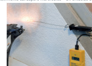
Después de 20 minutos temperatura superficial: 856°C
