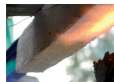
Barra de acero cubierto con Mortero THERMOSILIT® de cal/yeso Temperatura inicial: 19°C-
