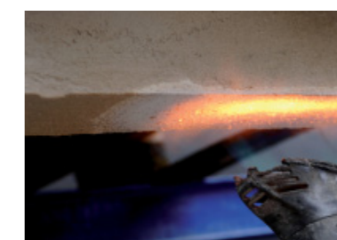
Después de 30 minutos- Temperatura de superficie: encima de los 1000°C- Sin daños a la barra de acero
