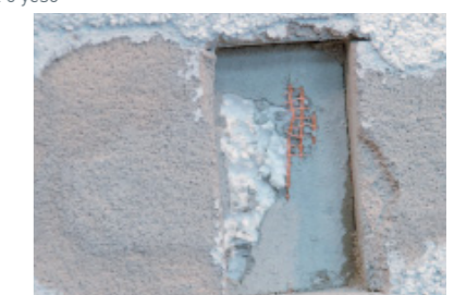
Después de 30 minutos temperatura de la superficie: 1080°C sin daños causados al aislamiento Styrofoam
