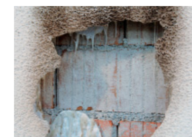
Después de 35 segundos El aislamiento Styrofoam se desintegra Temperatura de la superficie: Menos de 1000°C
