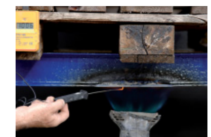
Barra de acero sin Mortero THERMOSILIT® de cal/yeso después de 7 min. - temperatura superficie: por encima de los 1000° - Barra de acero comienza a fundirse
